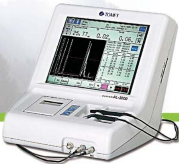
*Medición de longitud axial y espesor corneal*
